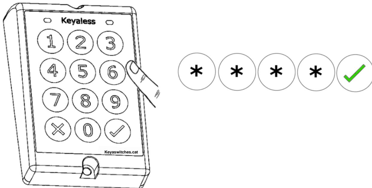
8.1. Una vez se tiene un código de usuario creado, puede introducir directamente el código de usuario. Si es válido realizará 2 pitidos cortos con 2 parpadeos del LED VERDE y se quedará encendido el LED VERDE mientras esté funcionando.
